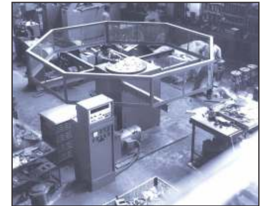
A 7000 kg. capacity machine used for stage balancing of gas turbines. Machine à capacité de charge de 7000 kg utilisée pour l'équilibrage Par étape de turbines à gaz.
