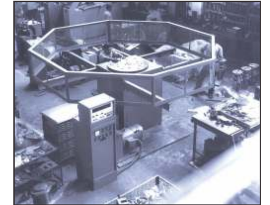
A 7000 kg. capacity machine used for stage balancing of gas turbines. Machine à capacité de charge de 7000 kg utilisée pour l'équilibrage Par étape de turbines à gaz.
